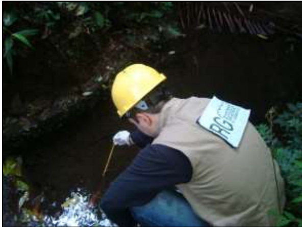
Toma directa de temperatura (Bocatoma Pajarito)
